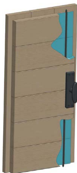
Applicazione dell'asta interna Application of internal rod
